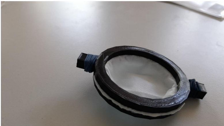
Siebeinsatz zum Filtern von verschmutztem Spül- und Badewasser aus dem 3D-Drucker
